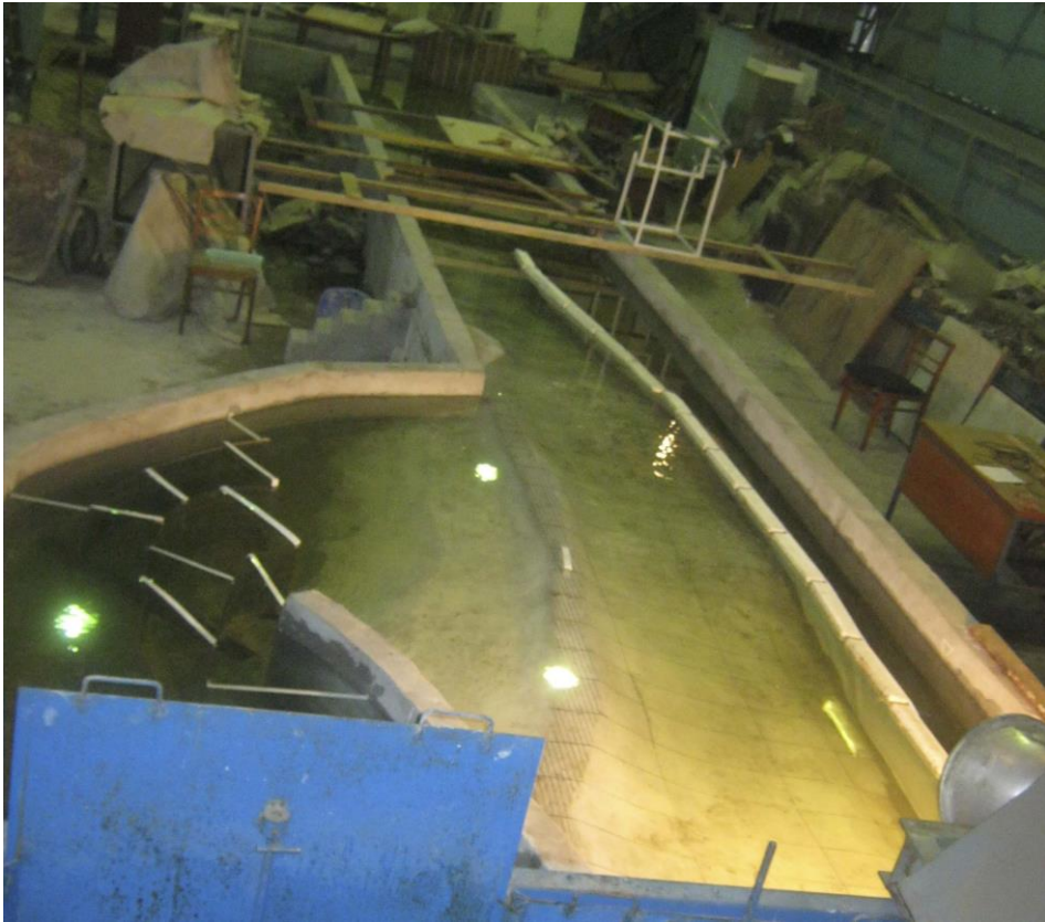
Рис. 1 – Модель струмененаправляючої споруди у гідродинамічному каналі
