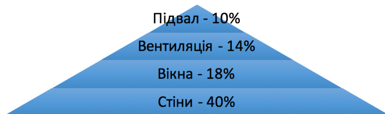
Рис. 2 – Схема тепловтрат житлових будинків через огорожувальні конструкції
