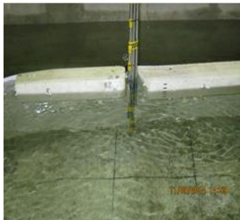
Рис. 6 – Измерение поля давления на полотне завесы модели струенаправляющего сооружения
