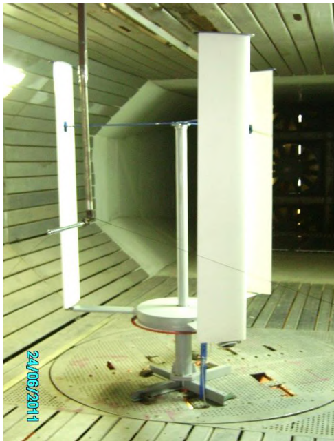
Рис. 5 – Ветроротор-3 (2012 г.) с механизмом управления № 2 в аэродинамической трубе НАУ
