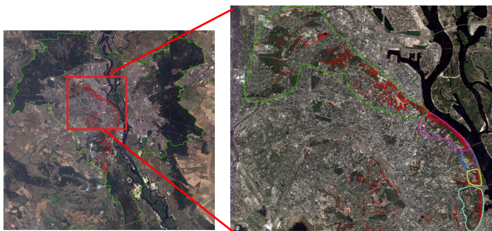
Рис. 1 – Синтезовані супутникові зображення зсувонебезпечних ділянок за параметром кута нахилу схилу: a – багатоканальний космічний знімок Landsat 8 міста Києва; б – багатоканальний космічний знімок QuickBird Придніпровської зсувної зони
