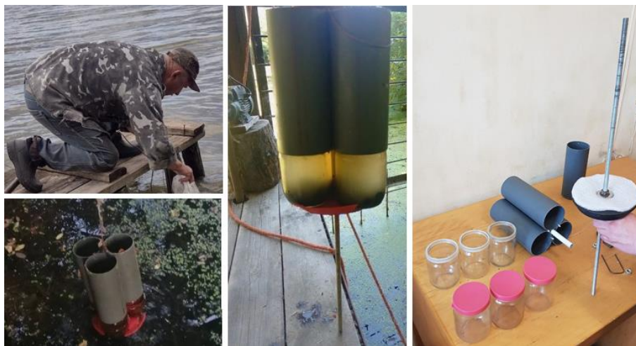
Рисунок 1. Седиментаційні пастки: процедура зняття, седиментаційні циліндри з відібраною речовиною, основні компоненти приладу
