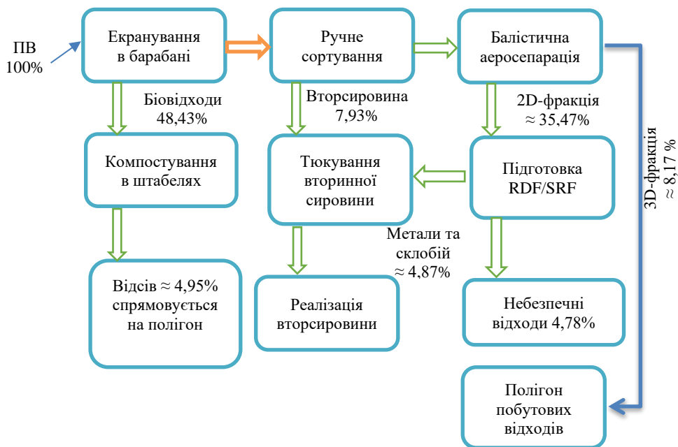
Рис. 3. Розподілення балансу відходів на установці механіко-біологічного оброблення
