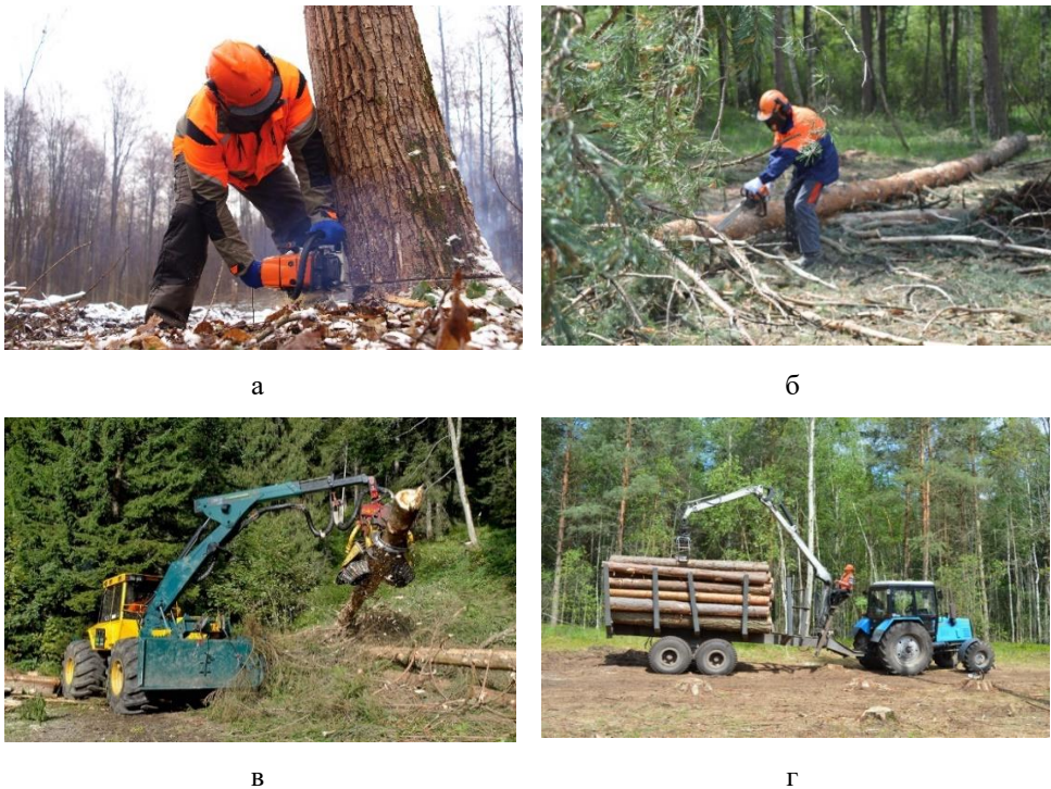
Рис. 2. Основні виробничі операції технологічного процесу здобутку деревини: звалювання дерев (а), очищення дерев від гілок та сучків (б), трелювання хлестів (в), навантажування хлестів (г)
