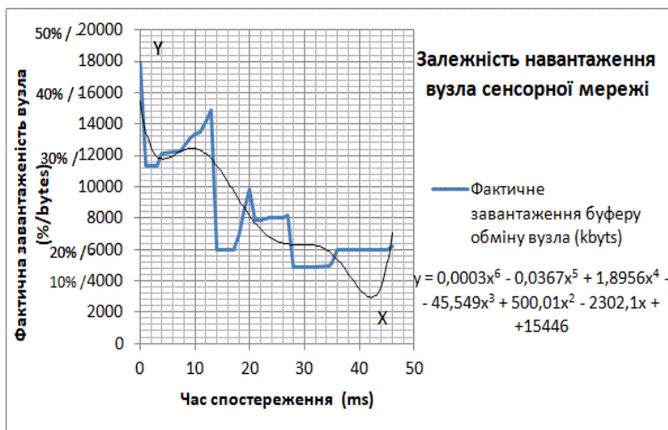
Рис. 1 – Залежність завантаженості обчислювальної системи вузла СМ від часу процесу ПД
