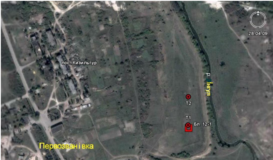
Рис. 10. Схема установки датчиків сейсмографа Blast Mate Series III на поверхні під час відпрацювання блоками ПВ: T_1 , T_2 – точки сейсмічних вимірів від вибухів
