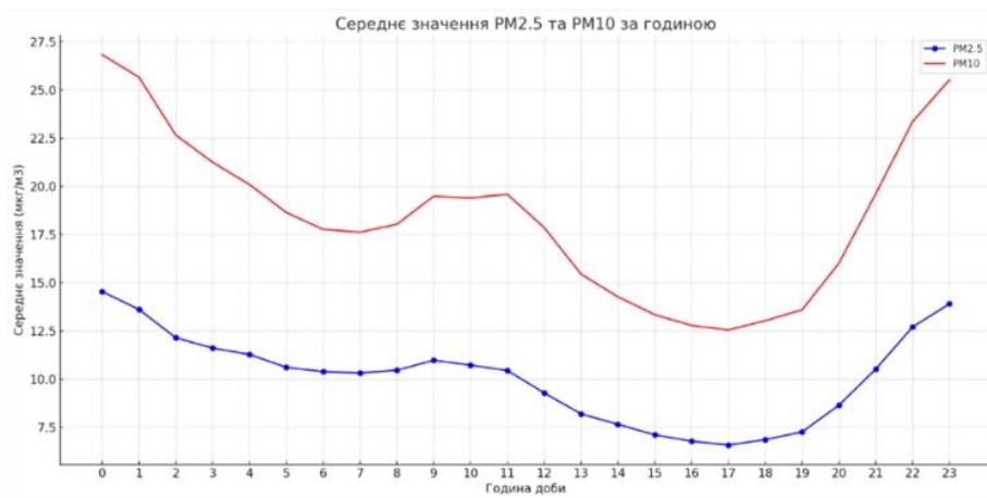
Рис. 3. Порівняння середньогодинних змін концентрацій частинок пилу PM_{2,5} та PM_{10} в м. Івано-Франківську
